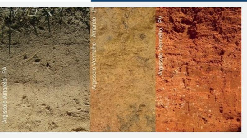
A resposta e a solução não é uma forma de bolo, ela deve ser feita baseada na análise prévia e conhecimento do tipo do solo e inspeção in loquo. O argissolo que contém 15% de silte e até 80% de argila variam de cor e possuem a propriedade de retenção de água, que devido a isso vai fazer que o solo esteja pronto para um ensaio em período mais longo.
